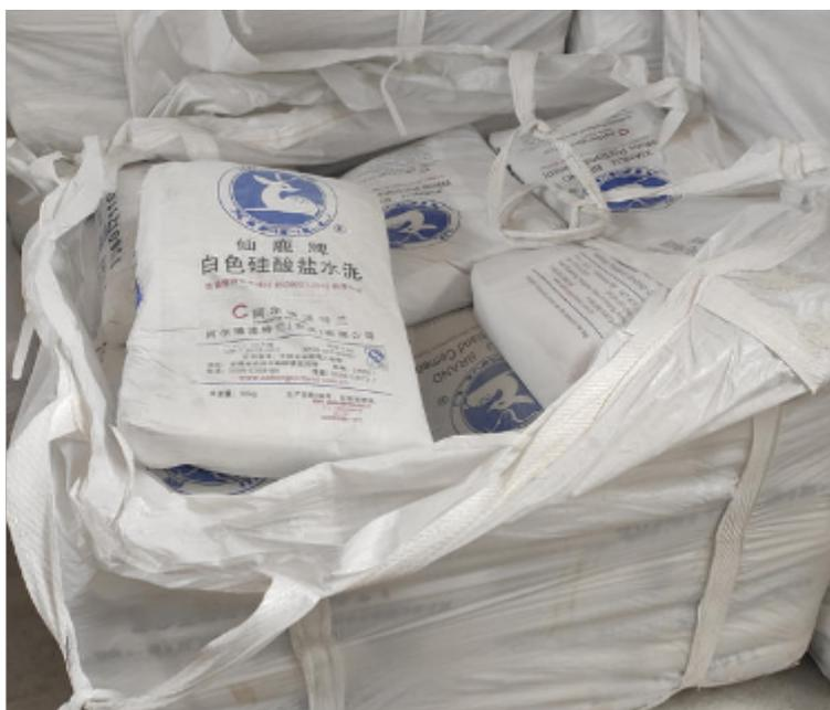
白水泥不能当黑水泥用。白水泥是白色硅酸盐水泥，铁含量少，市场上白水泥一般都是装修时用的，强度一般都比同等级黑水泥低。黑水泥为黑灰色硅酸盐水泥，主要是在建筑中使用，比如混凝土，砂浆等。白水泥以硅酸钙为主要成份，是铁度含量极少的硅酸盐熟料经漂白处理，加入适量的石膏磨细制成的白色硬性胶凝材料。要用于建筑装饰工程的勾白瓷片的缝隙、粉刷、雕塑、地面、楼梯亭柱台阶的装饰和制造各种颜色水沙石、水磨石制品，若在白色水泥中渗入适量的耐碱色素，可制成彩色水泥。白水泥的强度比普通水泥的强度低，不能做结构用。而工程建设中大量使用的水泥为普通硅酸盐水泥，颜色黑灰色，称之为黑水泥。一般这种水泥强度高粘接力强，具体值依标号不同而不同。
